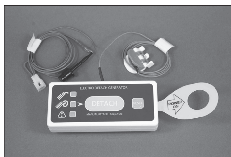
図6 エレクトロデタッチジェネレーター 音と光(ランプ)でCoil離脱ポイントを判定することが出来る。 カナメメディックスより提供
